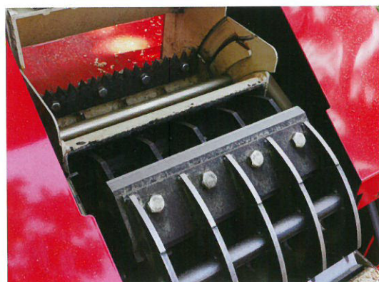
ナイフ式の内部構造。ナイフは180度回転させれば二度使える仕組み。
