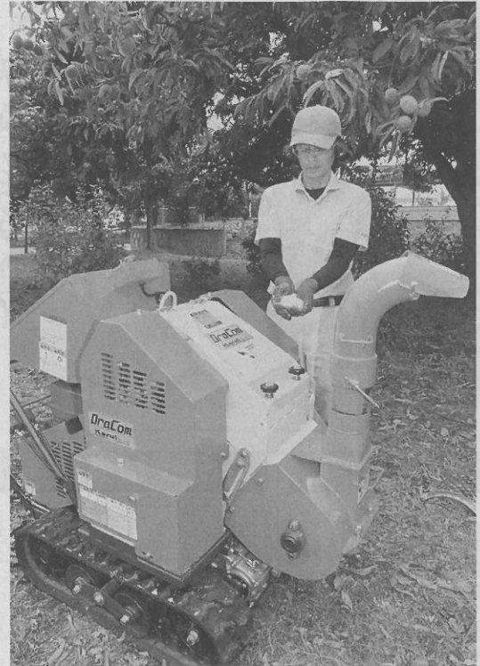
太い枝も処理できるナイフ式の樹木粉碎機ドラコンKDC-1301B (山形市で)
