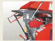
後進走行時、一定の力で押されると走行クラッチが切れ停止しますので、障害物挟圧事故防止に役立ちます。
