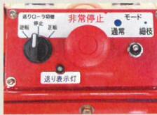
ローラー負荷を瞬時に読み取り送りローラーを自動コントロールしますので、無理の無い作業が行えます。
