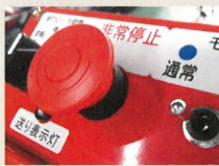
緊急時、非常停止ボタンを押すと送りローラーとエンジンがストップし、巻き込み事故を防止します。
