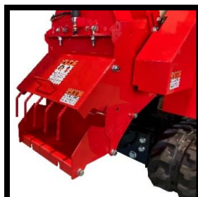
ブローダクト排出
